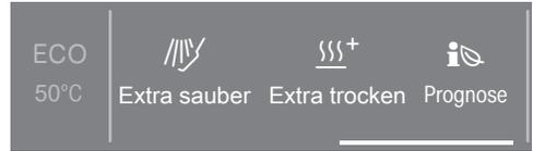
Nach Anwahl eines Programms wird das Menü „Extras“ angezeigt. Hier können Sie die gewünschten Extras wählen, den Timer aktivieren und mit der Funktion
